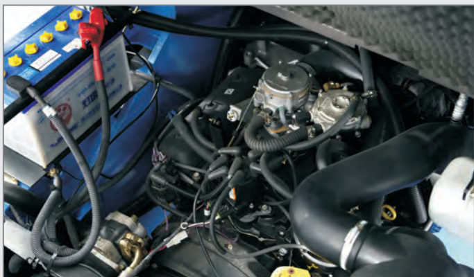
Kraftvolle Sechszylindermotoren von GM und effiziente IMPCO-Verdampferanlagen für Leistung und eine saubere Verbrennung.
