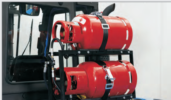
Die optionale Doppelflaschenhalterung erhöht die Reichweite und Nutzungsdauer der Stapler um bis zu 50%.
